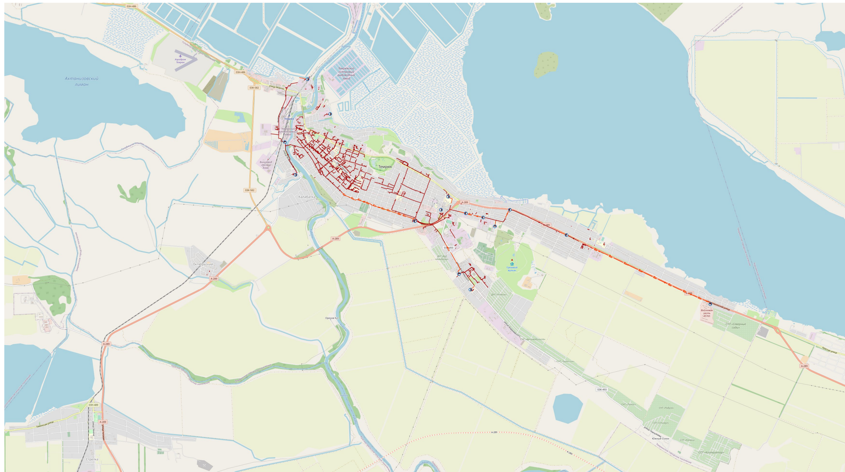
Рисунок 17 – Схема сетей водоотведения на территории Темрюкского городского поселения
